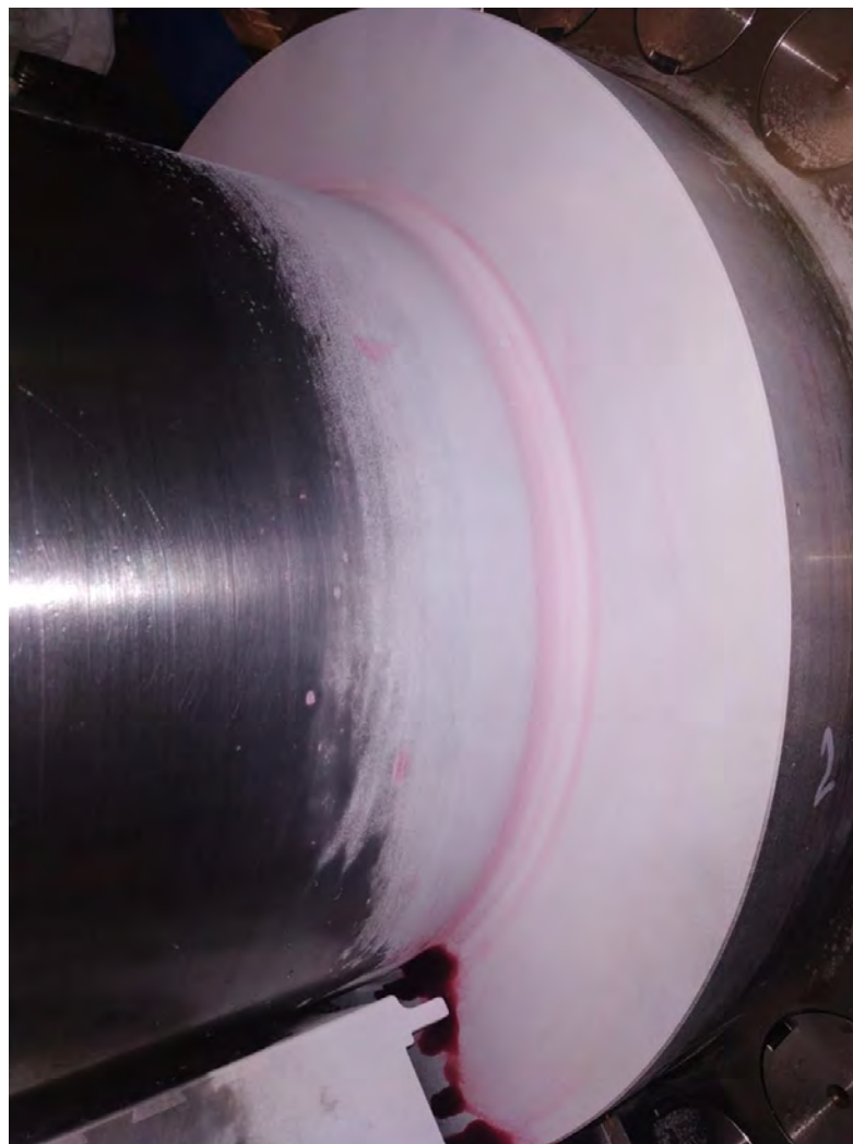
Цветная дефектоскопия после проточки и шлифовки
