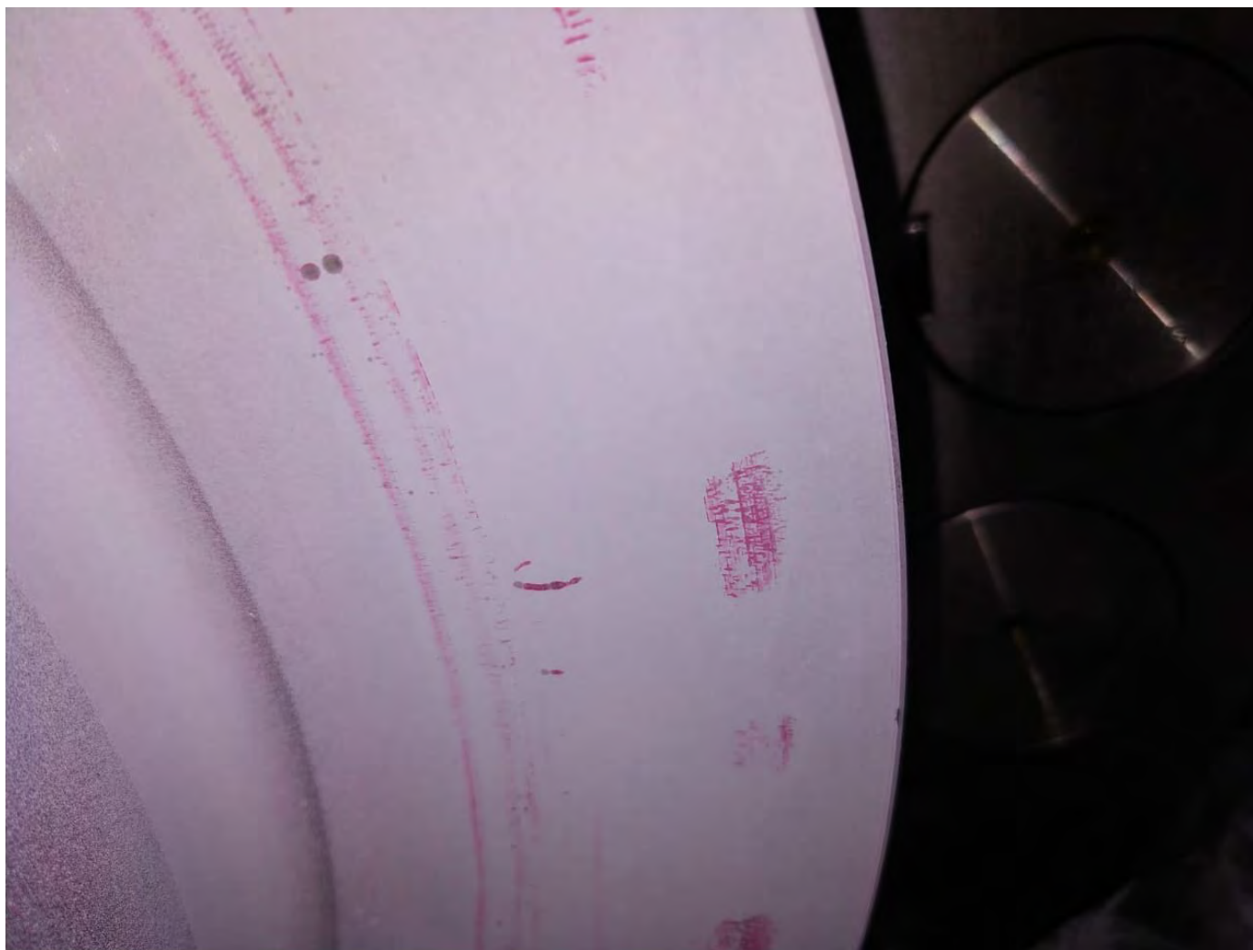
Цветная дефектоскопия до ремонта
