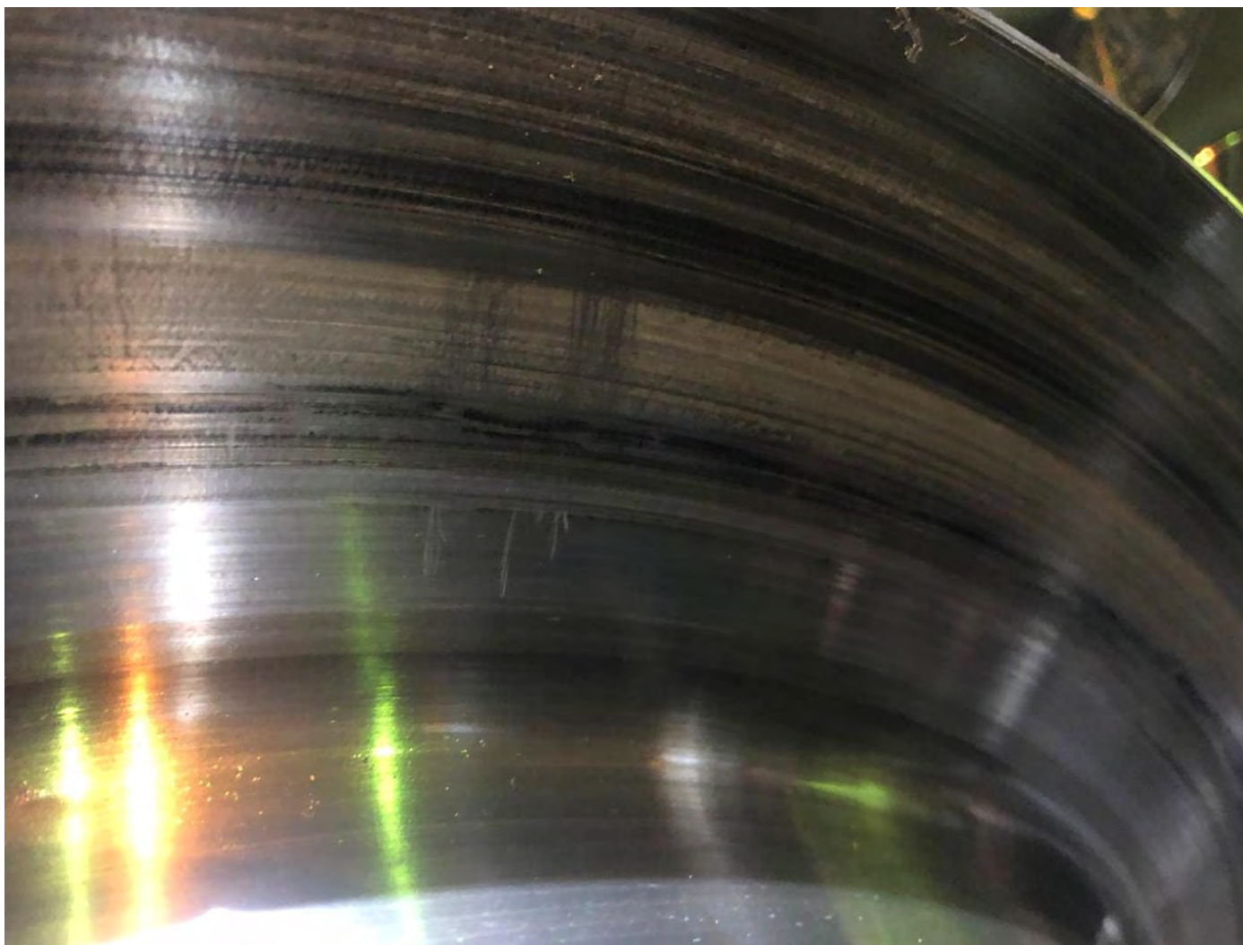
Поврежденный упорный гребень
