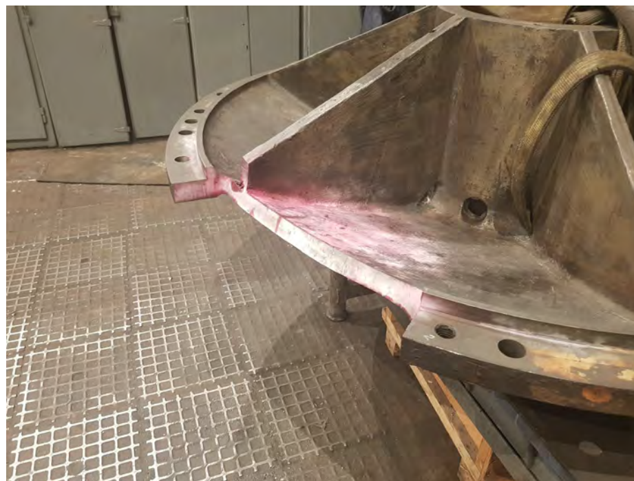
Обработка вылома под ремонтную вставку
