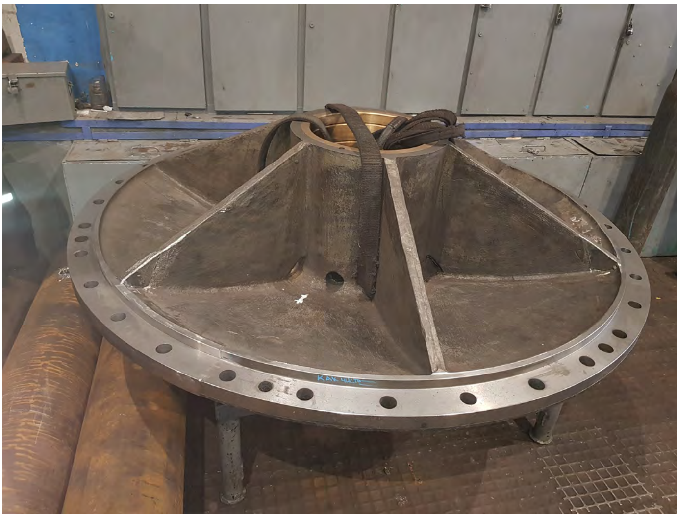
Отремонтированная крышка гидроагрегата
